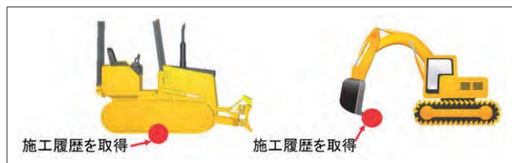
図6.1 施工履歴データ取得箇所
