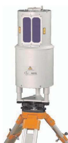
図1 地上型レーザの外観と計測システム例
